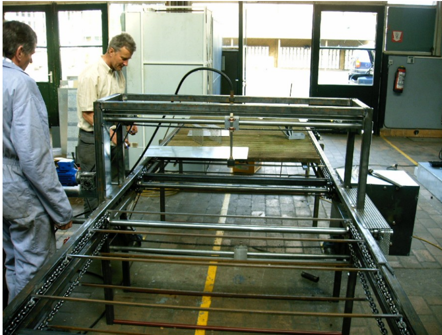
Figuur 45: testopstelling met spuitkop op loopblokje
