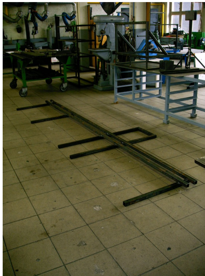
Figuur 32: de gepunte constructie
