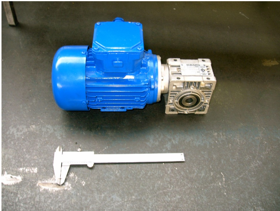
Figuur 43: motor met reductie voor aandrijving sproeikoppen
