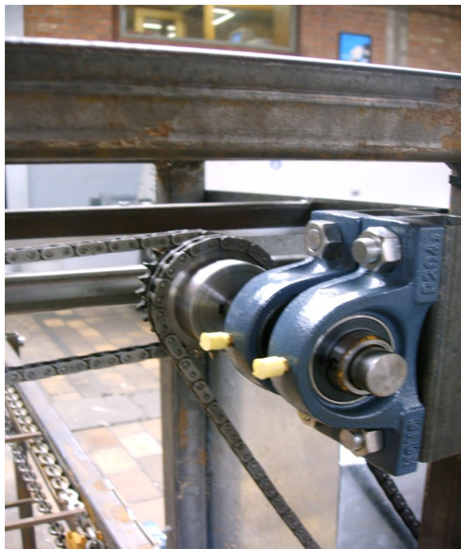
Figuur 44: verbinden van het sproeikopsysteem met de aandrijfmoter
