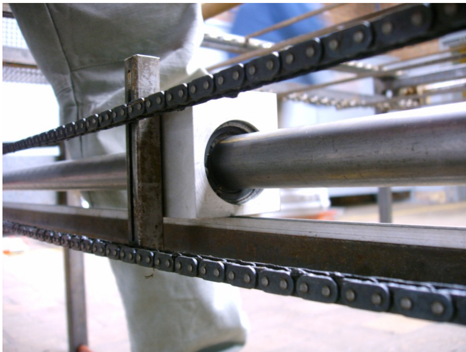
Figuur 13: gemonteerd loopblokje
